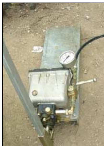
Particolare della pompa con manometro
